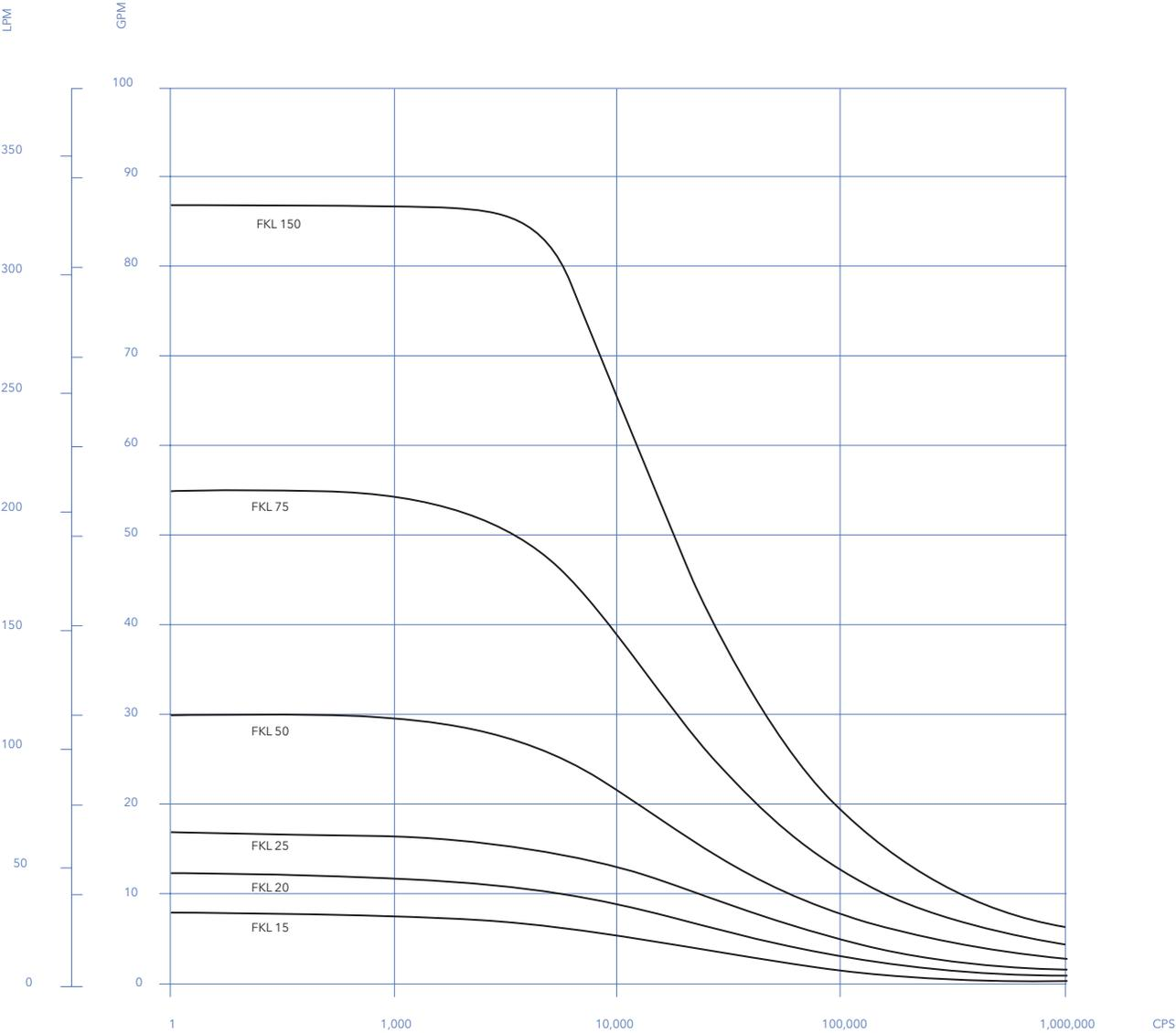
Curva de rendimiento basada en pruebas con agua a 21.1° C y 0 bar presión de entrada. El rendimiento real puede variar según la aplicación o el producto.
