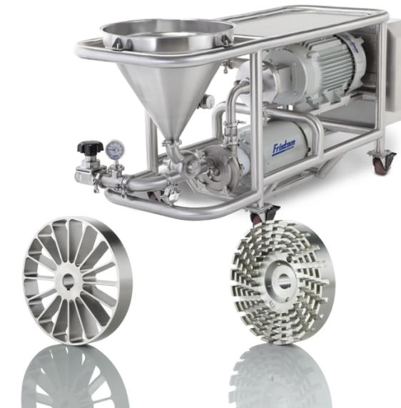
O Powder Mixer da Fristam oferece uma mistura rápida e de alto desempenho de ingredientes pós ou líquidos em um meio líquido. A indução contínua de pós através da bomba de anel líquido FZX e a eficiente homogeneização promovida pela FS shear blender garantem em sua maioria a dispersão em passagem única o que assegura redução de tempos de processo.
