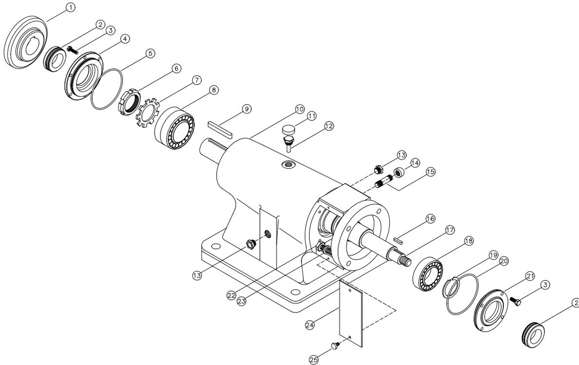
**FIGURE 24: FP 3VR-BEARING BLOCK PUMP ASSEMBLY**
